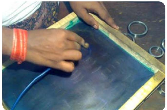
*Las marcas falsificadas se graban en los rodamientos utilizando pantallas de seda.*
